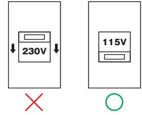
150W以上のMean Well スイッチング電源の側面に電源切替スイッチがあります。使用前に115Vに設定されていることを確認してください。
